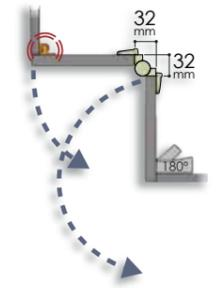
Compact occupe 32 mm dans des angles à 90° indépendamment de l'épaisseur des portes. Fonctionne parfaitement pour tout meuble d'angle supérieur à 75°
